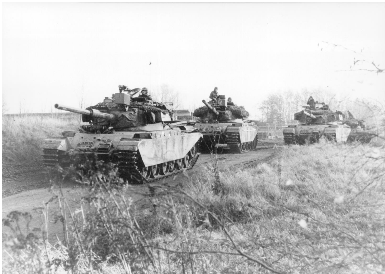
Kolonne af Centurion Mk. V kampvogne med 84mm kanon. Infrarød/hvidtlysprojektøren ses til højre for kanonen (Foto, Forsvarsgalleriet.dk).
