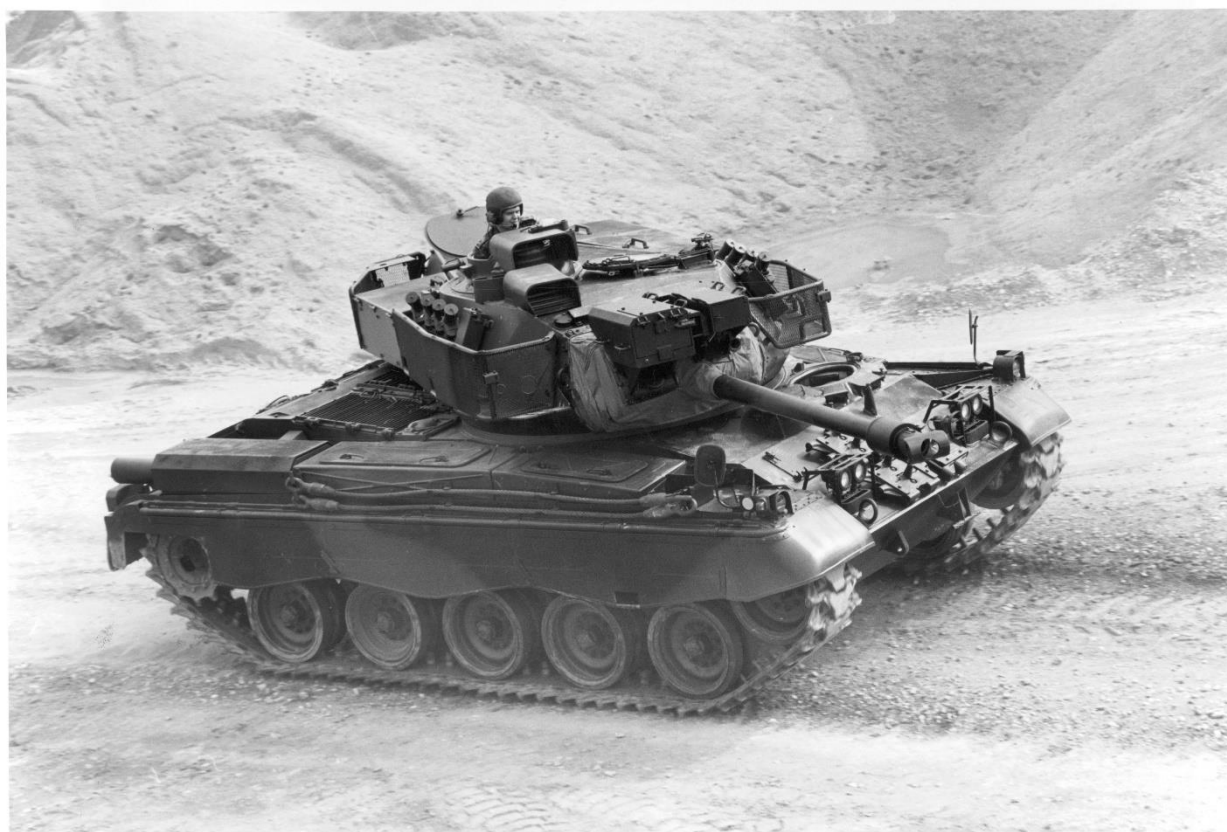
Let Kampvogn M41-DK1. Halogen-projektøren sidder i boksen over kanonen og det termiske sigte i boksen til venstre herfor. Laserafstandsmåleren er indbygget i skyttens sigteperiskop, der kan ses foran vognkommandøren og dennes periskop (Foto, Forsvarsgalleriet.dk).
