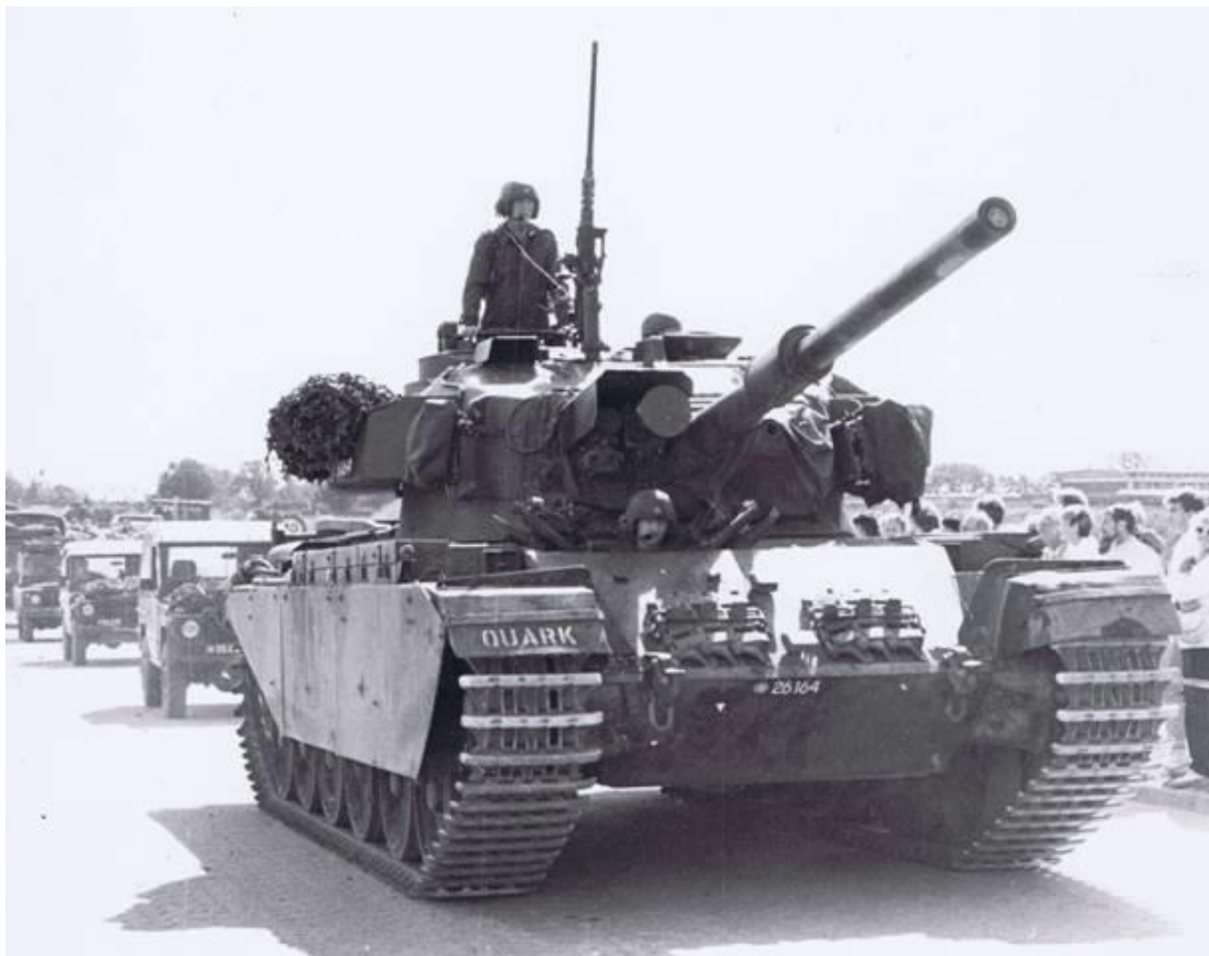
Centurion Mk.V.2-DK. Det lysforstærkende kamera og den termiske scanner sidder under skærmen til venstre for kanonen. Laserafstandsmåleren er indbygget i sigteperiskopet foran kommandørens kuppel. (Foto, Gardehusarregimentets Veteran Panser- og Køretøjsforening, Danske Hærhistoriske Museer).
