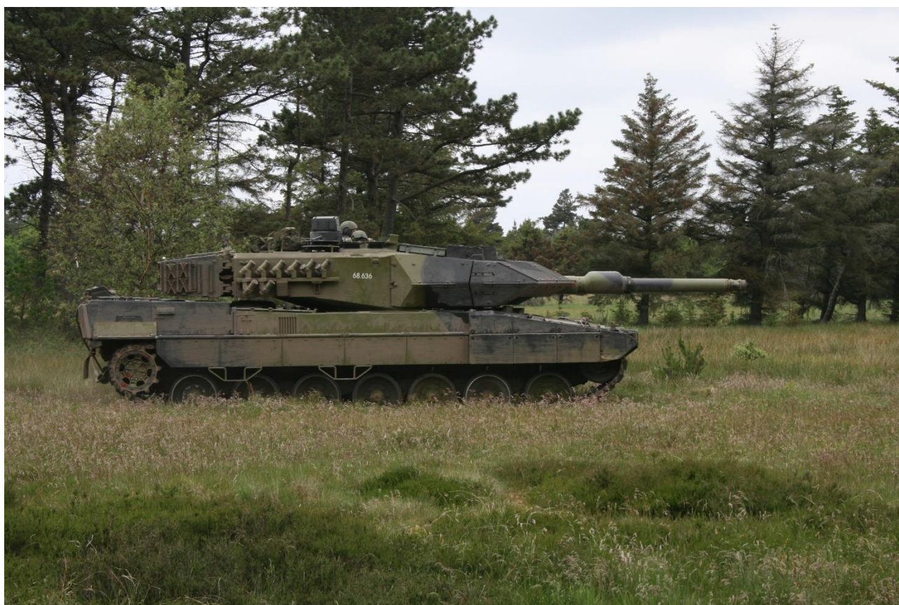
Leopard 2A5 kampvogn. Dette køretøj havde en af NATO's mest slagkraftige kanoner kombineret med tyk laminat- og hulrumspansring. På trods af dette havde Leopard 2A5 stadig fremragende bevægelighed og hastighed i terræn. (Foto, CVF Haven, 2007, Forsvarsgalleriet.dk)
