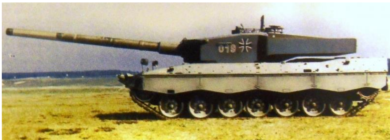
Leopard 2 kampvogn med 140mm kanon. Denne opgradering blev udtænkt for at imødegå truslen fra de kampvogne Sovjetunionen måtte udvikle i løbet af 1990'erne, hvis den Kolde Krig var fortsat. (Foto, Rheinmetall).
